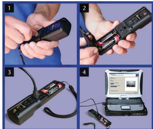
付属の USB ケーブルを使用してコンピュータの USB ポートに接続しますと自動的にダウンロードが始まります。上の写真①、②、③及び④の順です。
