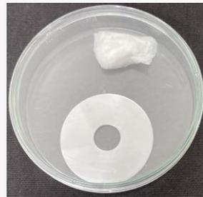
SKD材を塩水濃度3.5%に浸漬後ラストールNo.62に浸漬揺動し湿度調整したシャーレで保管12ヶ月後の写真
