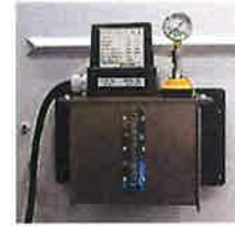
自動オイル潤滑 3軸の給油ポイントに定期的に給油します。
