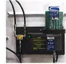
自動グリス潤滑 3軸の給油ポイント全てに定期的にグリス給油します。 *標準仕様は手動によるグリス給油になります。
