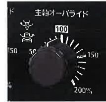
主軸オーバーライド プログラムを変更せずにスピンドル速度の変更ができます。
