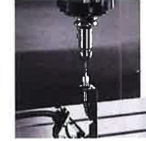
タッチ式工具折損検出 タッチスイッチ式の工具折損検出装置を用意。
