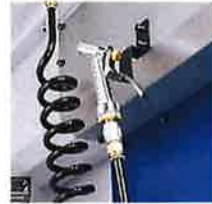
洗浄ガン 加工後のワーク清掃、機内の切粉清掃をやりやすくします。
