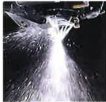
エアアシスト式ツール洗浄 高い吐出圧力・吐出流量によりホルダーに付着した切屑を強力に落とします。フィルター目詰まりワーニング機能装備。
